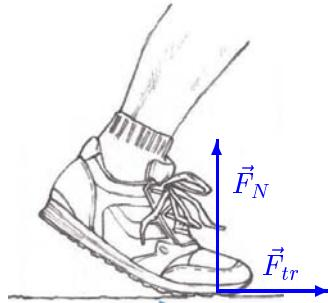
Ilustracija 3.37: Sila trenja  $\vec{F}_{tr}$  i sila pritiska podloge  $\vec{F}_N$  na dio sportske obuće koji je u dodiru s tlom.
