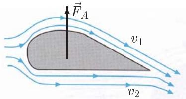
Ilustracija 3.46: Aerodinamička sila na nesimetrično tijelo u gibanju kroz fluid.
