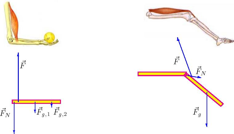
Ilustracija 1.2: Primjeri fizičkih modela ruke i noge čovjeka. Za određivanje gibanja pojedinih segmenata tijela potrebno je odrediti ona svojstva toga segmenta koja su važna u opisu gibanja, te sve sile koje djeluju na njega.
