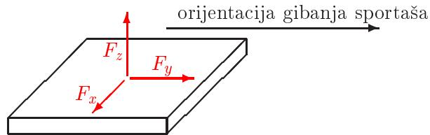
Ilustracija 4.4: Vektorske komponente sile reakcije mjerene pomoću platforme za mjerjenje sila.
