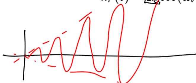
Rezonancija nastaje kada je frekvencija pobude  $\omega_v$  jednaka frekvenciji sustava  $\omega\sqrt{1 - \zeta^2}$ . Očituje se u rastućim amplitudama oscilacije sustava, unatoč umjerenoj snazi pobude.
